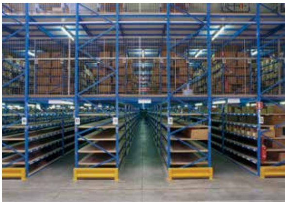
Mehrgeschossige Bühne realisiert aus Standard-Palettenregalkomponenten.
