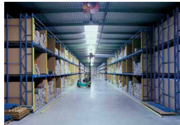
Teppichregale zur horizontalen Lagerung von Teppichen, mit seitlicher Verkleidung und Schutzvorrichtungen.
