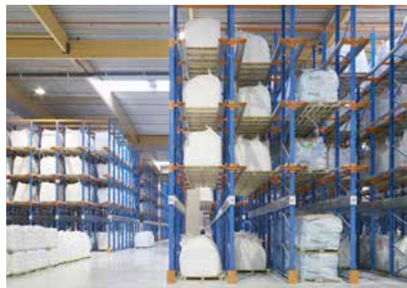
Einseitige Einfahrregale für Paletten mit Bigbags.
