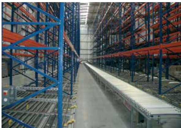
Bodendurchlaufbahnen für die Kommissionierung.
