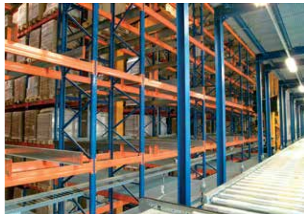
Shuttlesystem, Führungsschienen auf Standardtraversen.
