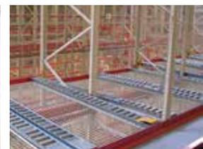
Abgitterung zwischen doppelten Rollenbahnen; manuell bedienbarer Separator.
