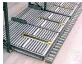
Vorderseite der Rollenbahn für die Beförderung von leeren Paletten.
