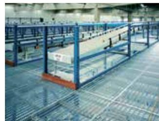
► Gitterroste sorgen für eine gleichmäßige Luftzirkulation.
