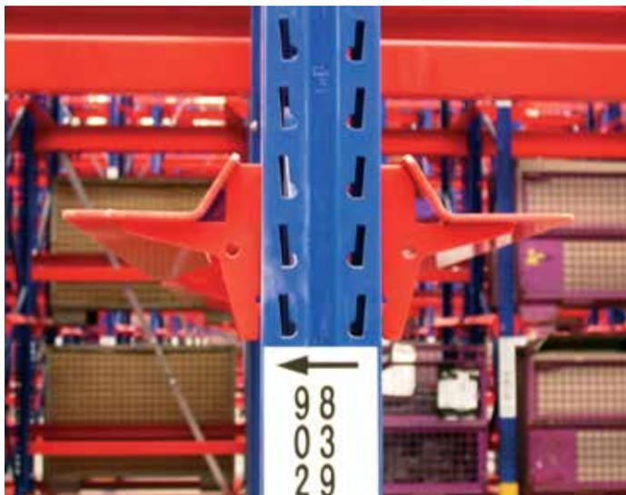
Wird das System mit speziellen Komponenten wie oberer Führungsschiene und Auskragungen ergänzt, kann es als Automatiklager betrieben werden.
